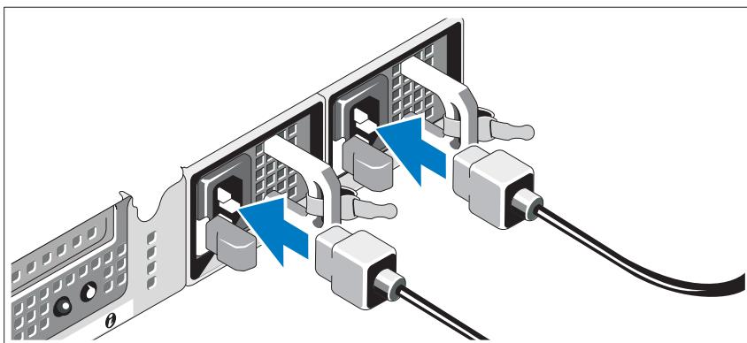
Verbinden Sie das bzw. die Netzstromkabel mit dem System.
