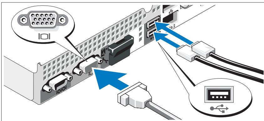
Подключите клавиатуру, мышь и монитор (дополнительно).
