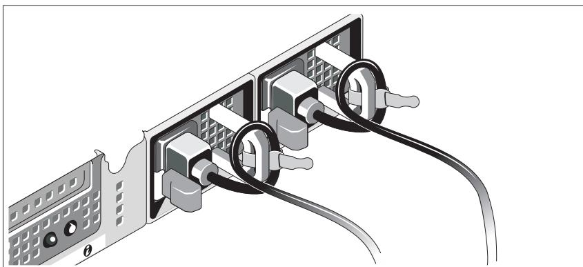
Zegnij kabel (kable) zasilania komputera w pętlę, w sposób przedstawiony na rysunku i zamocuj kabel na wsporniku, używając załączonej opaski. Podłącz drugą końcówkę kabla (kabli) do uziemionego gniazdka elektrycznego lub oddzielnego źródła zasilania, np. do zasilania bezprzerwowego (UPS) lub do jednostki rozdziału zasilania (PDU).
