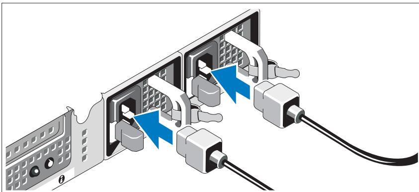
Conecte los cables de alimentación al sistema.
