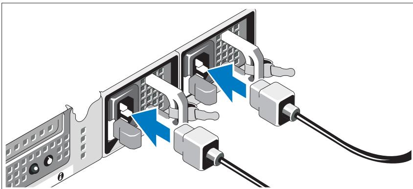
Připojte napájecí kabel(y) k systému.
