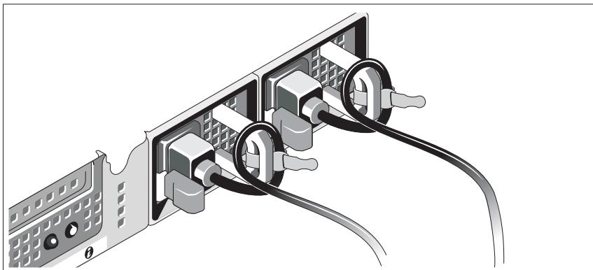
Bilden Sie mit dem(n) System-Netzstromkabel(n) wie abgebildet eine Schlaufe, und sichern Sie das/die Kabel mit dem beigefügten Riemen an der Klammer. Verbinden Sie das andere Ende des Kabels jeweils mit einer geerdeten Steckdose oder mit einer separaten Spannungsquelle, etwa einer unterbrechungsfreien Stromversorgung (USV) oder einem Stromverteiler (PDU).
