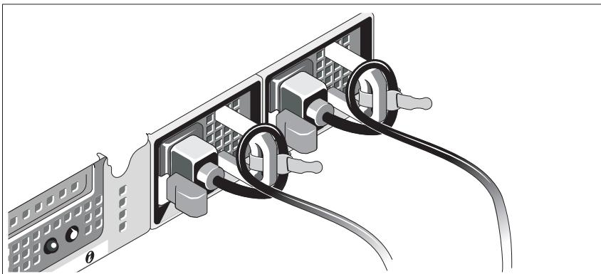
Sistemin güç kablosunu resimde gösterildiği gibi ilmek yapın ve kabloyu sistemle birlikte verilen şeridi kullanarak desteği sabitleyin. Güç kablosunun diğer ucunu topraklı bir elektrik prizine veya kesintisiz güç kaynağı (UPS) veya güç dağıtım birimi (PDU) gibi ayrı bir güç kaynağına takın.
